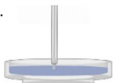
b. 将毛细管浸入液体中 (2 ... 3 mm)。
