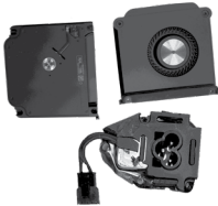
Ventiladores y entrada de CA
