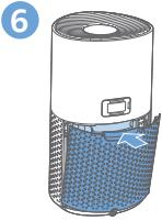
2 Потяните за заднюю крышку и снимите ее с прибора.
