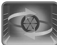
**Fonction Pizza :** Le voyant du thermostat et les voyants d'avertissement du four s'allument, les résistances circulaire et inférieure commencent à chauffer et le ventilateur se met à tourner. La fonction Pizza convient à la cuisson uniforme d'aliments comme les pizzas sur un court laps de temps. Le ventilateur répartit uniformément la chaleur dans le four, tandis que la résistance inférieure cuît les aliments.
