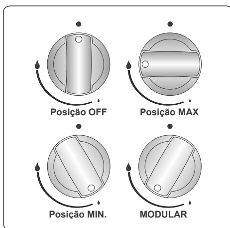
Após acender, verifique visualmente as chamas. Se vir uma ponta amarela, chama levantada ou instável, desligue o fluxo de gás e depois verifique a unidade das tampas do queimador e as bocas assim que tiverem arrefecido. Certifique-se de que não existe líquido nas tampas do queimador. Se o queimador acender accidentalmente, desligue os queimadores, ventile a cozinha com ar fresco e aguarde, pelo menos, 90 segundos antes de tentar acender novamente.
