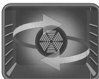
**Fonction Turbo :** Le voyant du thermostat et les voyants d'avertissement du four s'allument, la résistance circulaire commence à chauffer et le ventilateur se met à tourner. La fonction Turbo répartit uniformément la chaleur dans le four et assure une cuisson uniforme des aliments sur tous les niveaux. Il est recommandé de préchauffer le four pendant 10 minutes environ.
