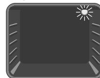
**Luz del horno:** Solo se encenderá la luz del horno. Seguirá encendida mientras esté activada la función de cocción.
