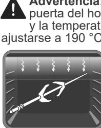
**Advertencia:** Al cocinar al grill, la puerta del horno debe estar cerrada y la temperatura del horno debe ajustarse a 190 °C.
