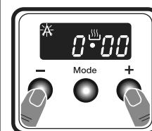
1. Appuyer simultanément sur les touches « + » et « - ». Le symbole apparaît et le point au milieu de l'écran se met à clignoter.
