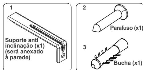
O saco de documento contém um kit anti inclinação. Coloque livremente o suporte anti inclinação (1) na parede utilizando o parafuso (2) e a bucha (3) seguindo as medições indicadas na imagem e na tabela abaixo. Ajuste a altura do suporte anti inclinação para que fique alinhado com a ranhura no fogão e aperte o parafuso. Empurre o eletrodoméstico na direção da parede certificando-se de que o suporte anti inclinação é inserido na ranhura na traseira do eletrodoméstico.
