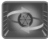
**Funzione Turbo:** il termostato e le spie del forno si accendono, e l'elemento riscaldante ad anello e la ventola si attivano. La funzione turbo distribuisce
