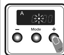
2. Ajuste la hora mientras esté parpadeando el punto mediante los botones "+" y "-".
