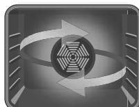
**Función Turbo:** Las luces de advertencia y del termostato del horno se encenderán y comenzarán a operar el elemento de calentamiento del
