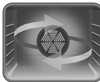
**Función de pizza:** Las luces de advertencia y del termostato del horno se encenderán y comenzarán a operar los elementos de calentamiento inferior del anillo y el ventilador. Esta función es ideal para hornear alimentos, como pizzas, de manera uniforme y en poco tiempo. El ventilador distribuye de forma homogénea el calor del horno, mientras que el elemento de calentamiento inferior se encarga de hornear los alimentos.
