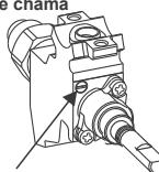
Válvula com dispositivo de falha de chama
