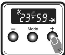
7. Il tempo di fine cottura deve essere considerato aggiungendo il tempo di cottura all'ora corrente. Ovvero, il tempo di fine cottura non deve essere inferiore all'ora corrente più la durata della cottura. È possibile impostare un tempo massimo successivo di 23 ore e 59 minuti.
