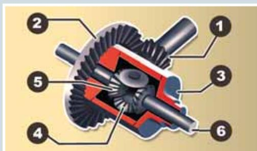
1. Rondsel: draagt vermogen van de motor over naar het kroonwiel en ten slotte naar de aandrijfwielden.
