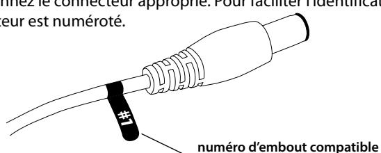
3. Fixez le connecteur choisi à l'extrémité du câble de sortie de l'adaptateur c.a.
