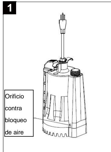
**PRECAUCIÓN:** Esta orificio es para fines contra bloqueo de aire. La fuga de aire o agua es NORMAL. ¡NO RETIRE NI ENCHUFE ESTA ORIFICIA!
