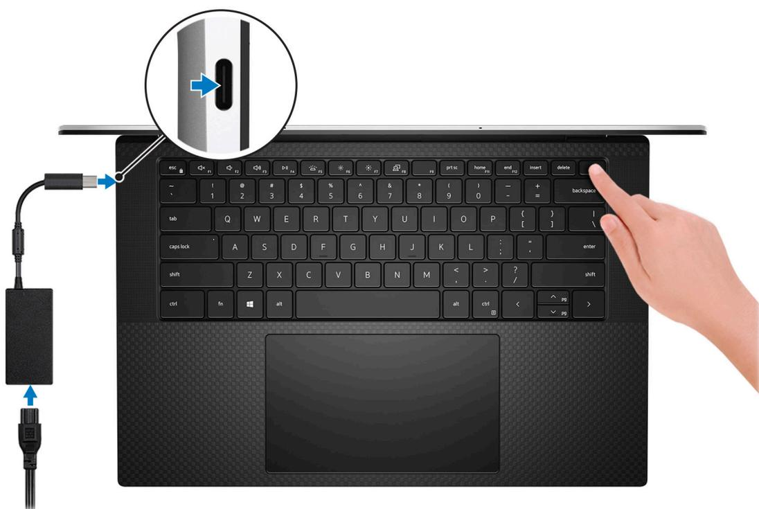
**i** **N.B.:** È possibile caricare il sistema collegando l'adattatore per l'alimentazione a una delle porte Thunderbolt 3 (USB Type-C) che si trovano sul lato sinistro del computer o alla porta USB 3.2 Gen 2 (Type-C) che si trova sul lato destro del computer.
