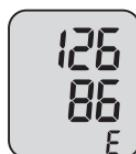
El valor del pulso no se puede determinar correctamente Compruebe la posición del manguito y repetir la medición.
