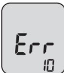
Err<br>!0 | Erreur lors de la connexion Bluetooth<br>Retirez les piles et appuyez sur le bouton START brièvement. Remettez les piles dans le boîtier. Recommencez le processus de connexion. Si l'erreur persiste, retournez l'appareil au fabricant pour réparation. |
