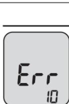
Err<br>10  | Fehler bei der Bluetooth-Verbindung<br>Entnehmen Sie die Batterien und drücken Sie kurz die START-Taste. Legen Sie die Batterien wieder ein. Führen Sie erneut eine Kopplung durch. Sollte der Fehler weiterhin bestehen, senden Sie das Gerät zur Reparatur an den Hersteller. |
