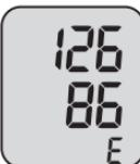
126<br>86<br>E                                        | Il valore della pulsazione non può essere correttamente determinato<br>Controllare la posizione del bracciale e ripetere la misurazione.                                                                                                                                                                                         |
