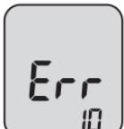
Err<br>10 | Errore nella connessione Bluetooth<br><br>Togliere le batterie e premere brevemente il pulsante START. Rimettere le batterie nello strumento. Eseguire nuovamente l'accoppiamento. Se l'errore persiste, rendere lo strumento al produttore per la riparazione |
