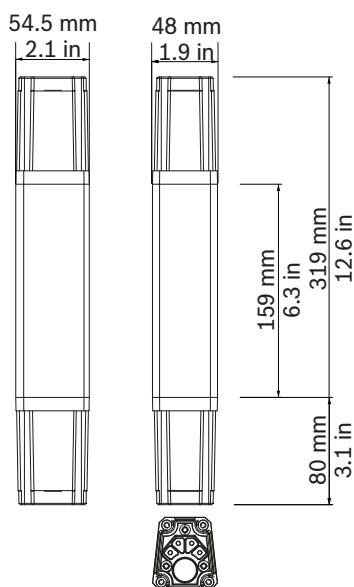
图片 9.2: EVOLVE 50短支撑杆的尺寸
