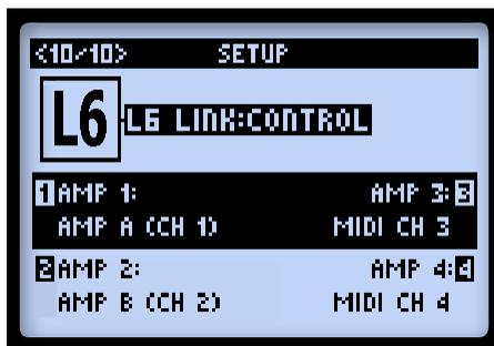
これらのオプションにより、接続した最大4台までのLine 6 DT50またはDT25アンプがPOD HD500 Ampモデル&セッティングにどのように追従するのかを設定することができます。DT50アンプ1~4に接続したL6 LINKに対して、パラメーター1~4がそれぞれ対応します。
