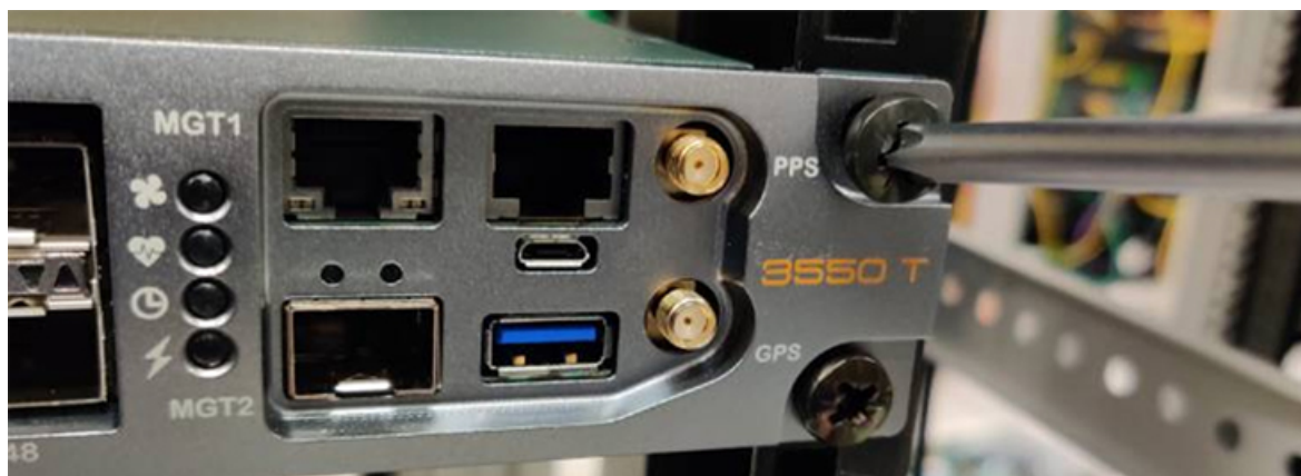
図 9: Nexus 3550-T を通常の方法で固定します。
