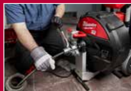
Механизм CABLE DRIVE осуществляет автоматическую подачу и смотку тросика
