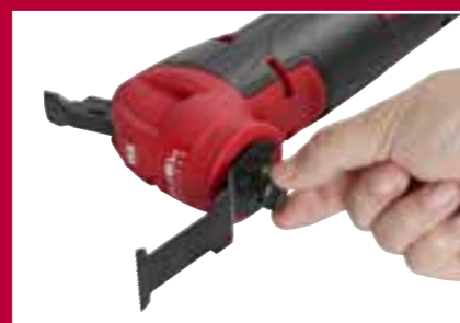
Безинструментальная смена насадок FIXTEC™ с универсальным адаптером для смены насадок
