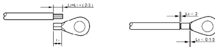
Fig. 3-5 Wiring stripping
