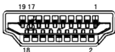
19-stykowy przewód sygnałowy kolorowego wyświetlacza
