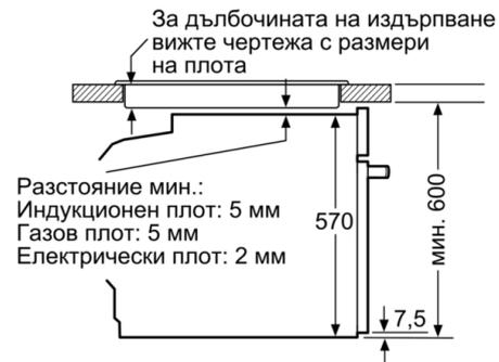
измерване в мм
