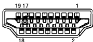
Câble de signal d'affichage couleur à 19 broches
