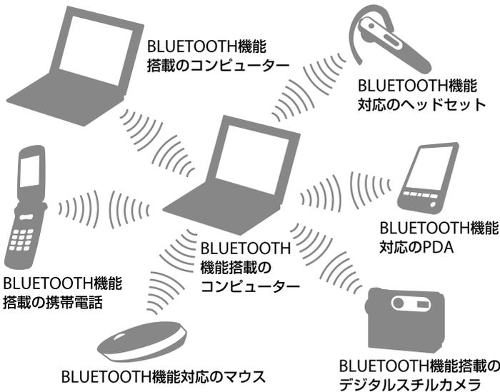
BLUETOOTH機能を使うと、1台の機器が同時に最大7台の機器と無線ネットワークで接続し、データをやりとりすることができます。
