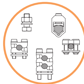
→ Возможные типы подключений: - шина с болтовым соединением - зажимная клемма - призматический зажим - "V" образный зажим
