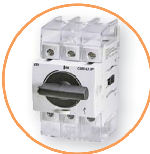
→ Клеммные крышки обеспечивают защиту от случайного прикосновения и разделение фаз выключателя, а наличие перфорации позволяет осуществлять контроль температуры контактов без снятия крышек
