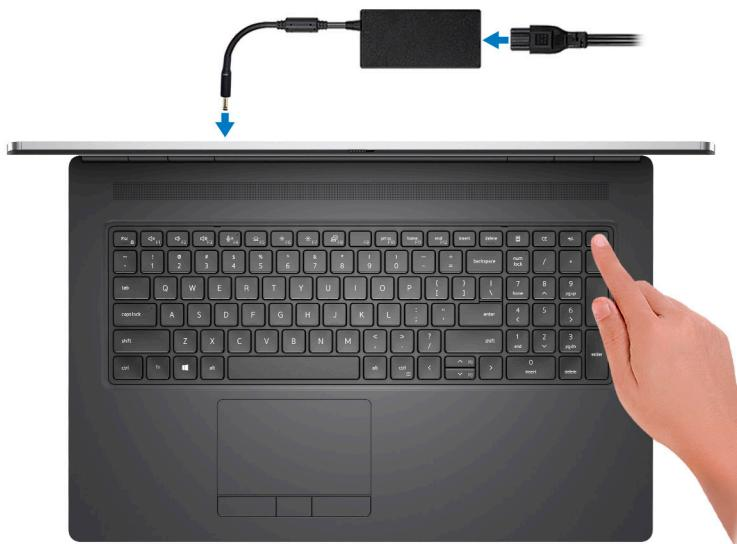
**(i) CATATAN:** Untuk menghemat daya baterai, baterai dapat masuk ke mode hemat daya. Sambungkan adaptor daya dan tekan tombol daya untuk menyalakan komputer.
