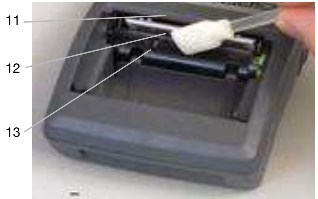
11 Papierabreisskante 12 Druckkopf 13 Papiersensor
