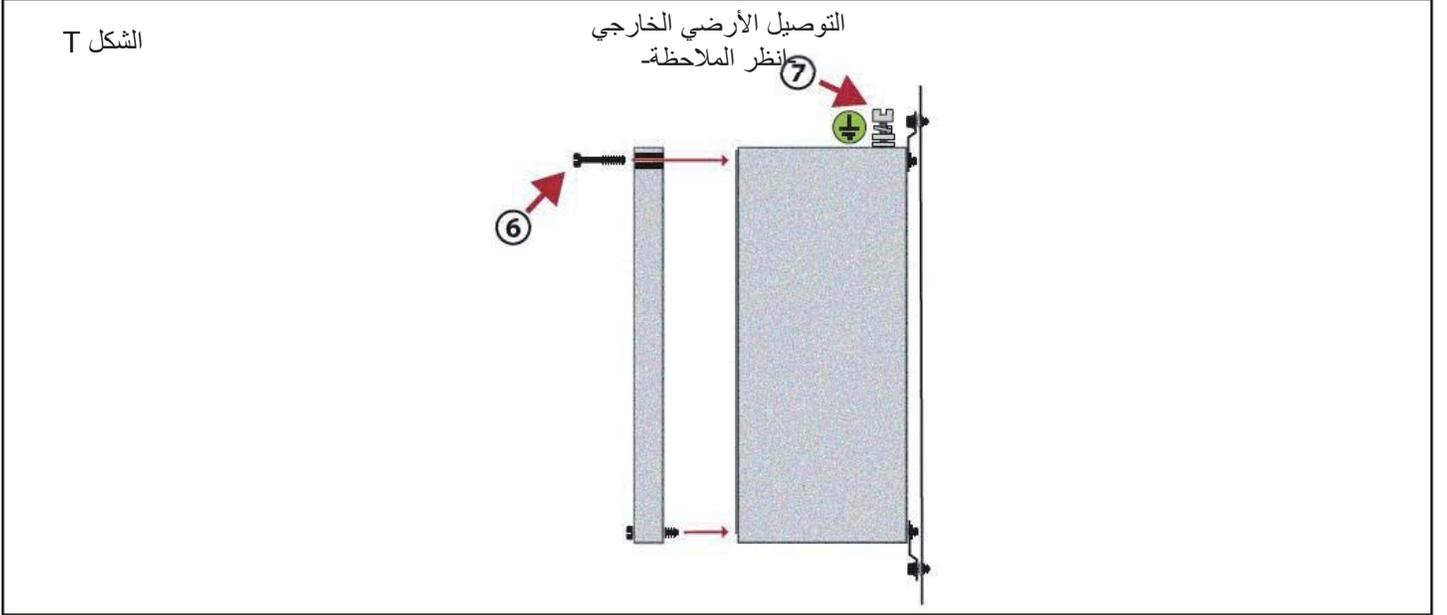
ملاحظة: يتم تركيب مكيف الهواء هذا وفقاً للوائح الوطنية لتوصيل الأسلاك المسارية في البلد الذي يتم تركيبه فيه. ويجب أن يقتصر إجراء التوصيلات الكهربائية للمعدات على الأفراد المؤهلين فقط وفقاً للمعيار (B)NEC/CEC 501.10 والمعيار EN/IEC 60079-19. ويجب إجراء الإصلاحات التي تمس حماية الموقع من المخاطر بواسطة كهربائي مؤهل وفقاً للمعيار (B)NEC/CEC 501.10 والمعيار EN/IEC 60079-19.
