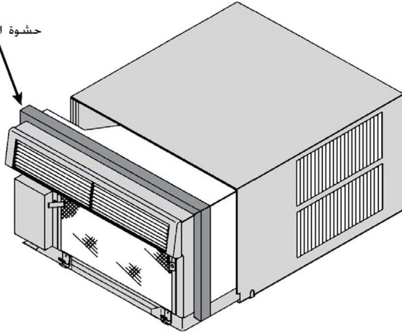
الخطوة: 2 تأكد من ان الفلتر في مكانه ثم قم بتركيب شبك الهواء الراجع (انظر الشكل Q). يمكن اسناد شبك الهواء على قاع دفاعة التصريف، اضغط الشبك في مكانه بدفع الشبك الى أعلى و داخل مزاليج الوحدة عند القاع.
