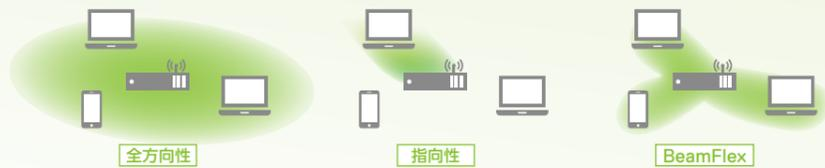
BeamFlex+ では、ラッカス BeamFlex アダプティブ アンテナ技術を進化させ、クライアント デバイスの場所に加えて、クライアント デバイスの向きにアンテナを適応させることができます。これにより、Rucks アクセスポイントは、デバイスの向きや特性に合わせて受信しやすい電波を送信することで、常に安定したワイヤレス環境を提供します。
