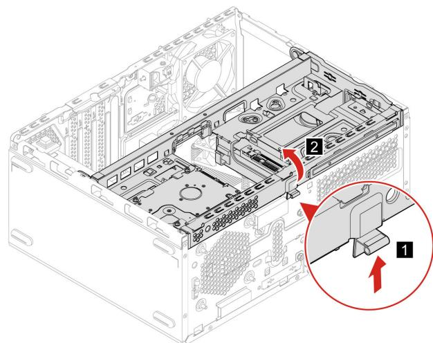
8. Снимите крепежную скобу устройства хранения данных.
