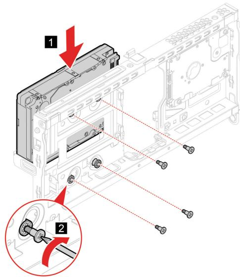
9. Поверните блок отсека для диска вниз; он должен зафиксироваться в нужном положении.
