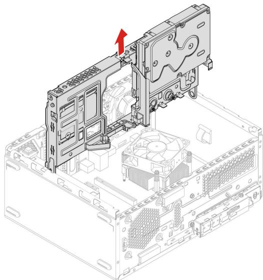
9. Установите новую крепежную скобу устройства хранения данных и поверните отсек для диска вниз.
