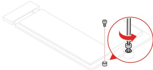
5. Извлеките твердотельный диск M.2.
