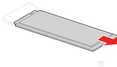
6. Установите твердотельный диск M.2.
