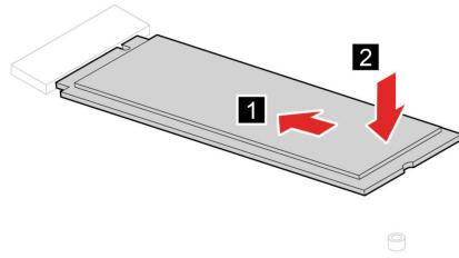
7. Закрепите твердотельный диск M.2 винтом.
