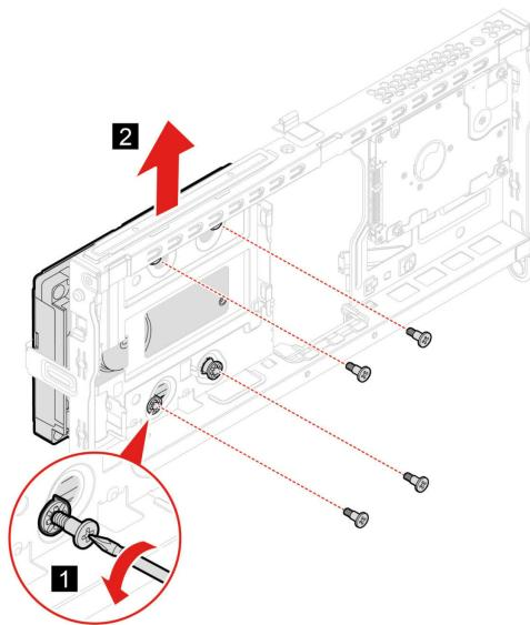
8. Установите устройство хранения данных и закрепите его винтами.
