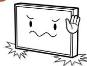
切勿将显示器按照如图所示竖立放置。面板易碎，竖立放置容易损坏。
