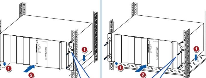
Montage mit Teleskopschienen
