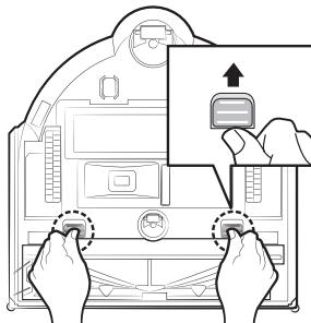
1 Потяните фиксатор крышки щетки вверх, чтобы разблокировать его.
