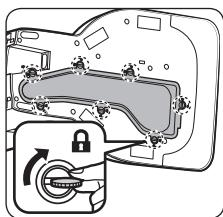
5 Поверните 7 фиксирующих винтов в направлении блокировки (🔒).
