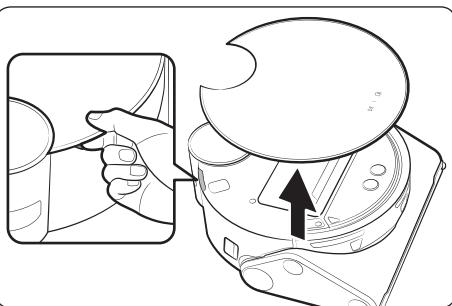
1 Снимите верхнюю крышку, используя паз под ней.
