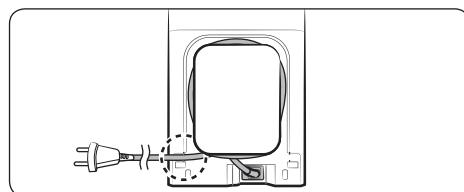
2 Вставьте кабель питания в фиксирующий паз на задней панели станции очистки.
