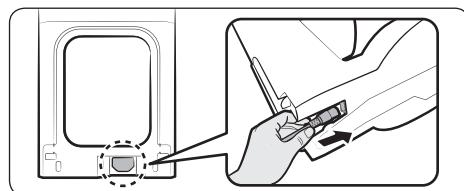
1 Подключите кабель питания из комплекта к нижней части станции очистки.
