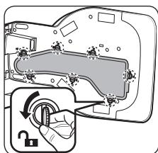
1 Положите станцию очистки на бок и поверните 7 фиксирующих винтов на нижней крышке в направлении разблокировки (🔓).
