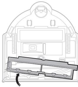
2 Снимите крышку щетки.
