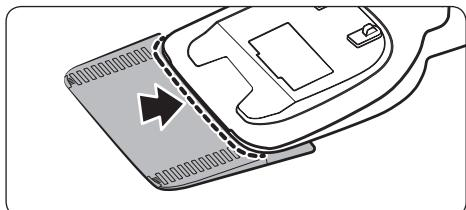
5 Опустите переднюю часть станции очистки так, чтобы ее передний край ровно встал в паз на дополнительной панели.
