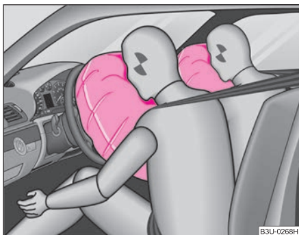
Изобр. 146 Раздутые подушки безопасности, заполненные газом
