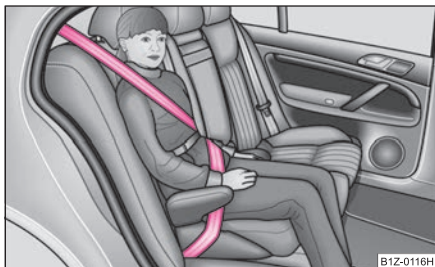
Изобр. 160 Специальное сиденье для ребенка категории 3, расположенное на заднем сиденье по направлению движения автомобиля
