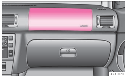
Изобр. 145 Надувная подушка безопасности для пассажира переднего сиденья в панели приборов
