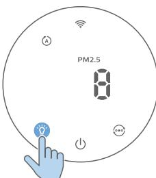
Nəzarət paneli işıq sensoru ilə ətraf işığa uyğun olaraq yana, sönə və ya tutqunlaşa bilər. Ətraf işıq tünd olduqda nəzarət paneli sönəcək və ya tutqunlaşacaq. Bütün işıqları yandırmaq üçün istənilən düyməyə toxuna bilərsiniz. Sonra başqa
