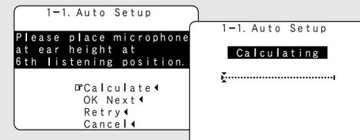
計算が終了すると測定結果の確認画面が表示されます。解析時間は接続されたスピーカーの数と測定ポイント数に依存します。接続するスピーカーの数と測定ポイントが多くなるほど、解析に要する時間は長くなります。測定ポイント数が6カ所以下でも測定を終了することができますが、より良い結果を得るためには6カ所の測定を推奨します。
