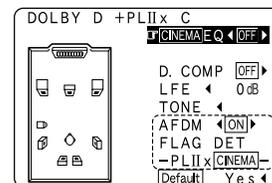
Dolby Digital EXモードで再生をおこないたい場合はAFDMを「OFF」に設定し、「SB CH OUT」で「MTRX ON」を選びます。
