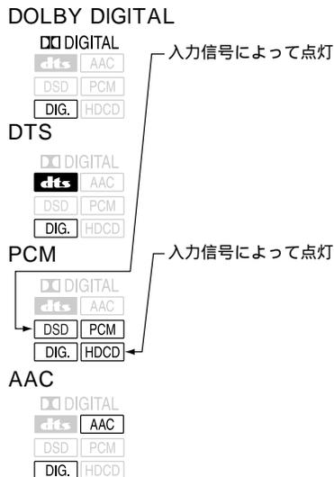
デジタル信号が正常に入力されると“DIG.”が点灯します。点灯しない場合はデジタル入力の設定(☞ 58ページ)や接続が正しいか、または機器の電源が入っているかを確認してください。
