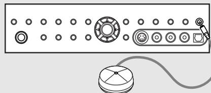
**2** セットアップマイクをカメラ用三脚などに取り付け、受音部を天井に向けた状態でリスニングルームのメインリスニングポイントに設置する
