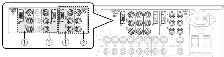
本機の映像出力は、HDMI、ビデオ、Sビデオ、D端子、コンポーネントケーブルのいずれかでモニター（TV）と接続します。
