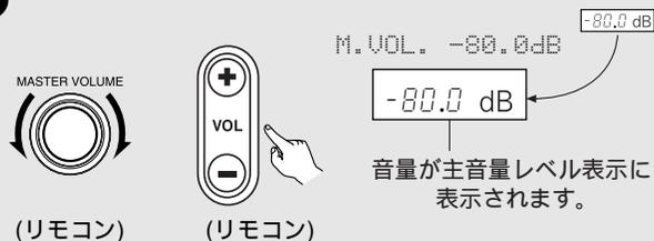
音量は -80 ~ 0 ~ 18dB の範囲で 0.5dB ステップで調節できます。ただし、45、46、72 ページに記載されている方法でチャンネルレベルを設定しているとき、どれか1つのチャンネルでも +0.5dB 以上に設定していると音量は 18dB まで調整できません。(この場合、音量の最大調整範囲は“18dB - チャンネルレベルの最大値”となります。)
