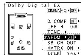
ドルビーデジタルEXで記録されているソフトには、EXフラグを含んでいないものがあります。再生中にAFDMが「ON」になっても再生モードが自動的に切り替わらない場合は「SB CH OUT」を「PLIIx Cinema」または「MTRX ON」に設定してください。また、サラウンドバックスピーカーを「スピーカーの種類・有り無しの設定」で「1spkr」に設定している場合は「SB CH OUT」を「MTRX ON」に設定してください。
