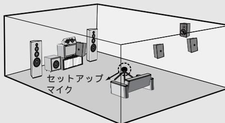
セットアップマイクを設置する際は、セットアップマイクの受音部分の高さがリスニング時の耳の位置に合うように高さを調整してください。
