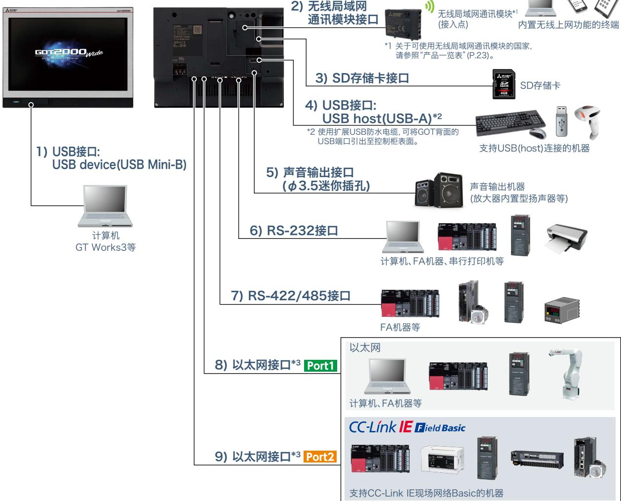
\*3 以太网接口(端口1/2)可与支持以太网或CC-Link IE现场网络Basic的机器连接。
