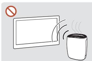
Глянцевая поверхность монитора требует особого ухода. Не используйте вблизи него ультразвуковой увлажнитель воздуха, который может оставить на устройстве белые пятна.
