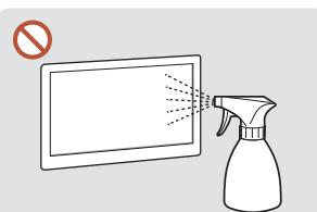
Не брызгайте воду непосредственно на устройство. Попадание воды в устройство может стать причиной повреждения устройства, поражения электрическим током или возгорания.
