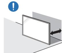
Устройство следует устанавливать на достаточном расстоянии от стены, чтобы обеспечить хорошую вентиляцию.
