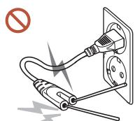
Не вставляйте никаких токовых проводников в розетку питания при подключенном к ней кабеле питания. Также не касайтесь контактов кабеля сразу после его отсоединения от розетки питания.
