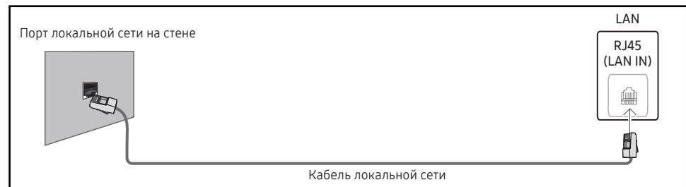
Если в вашей сети применяется динамическое распределение IP-адресов, необходимо использовать модем с поддержкой протокола DHCP. Модемы и маршрутизаторы с поддержкой DHCP автоматически пересыпают в устройство **IP-адрес**, **Маску подсети**, **Шлюз** и параметры DNS, необходимые для доступа к Интернету, и вам в этом случае не нужно вводить их вручную. В большинстве домашних сетей используется динамическое выделение IP-адресов.
