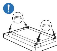
Обязательно используйте ручки на задней панели устройства при его перемещении.
