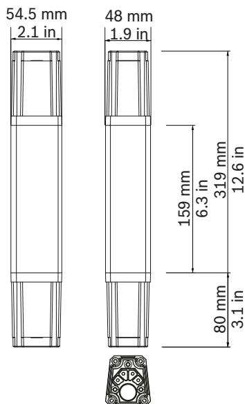
**Figura 9.2:** Dimensões EVOLVE 50 mastro curto
