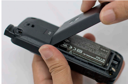
Figura 16: Rimozione dello sportello della batteria
