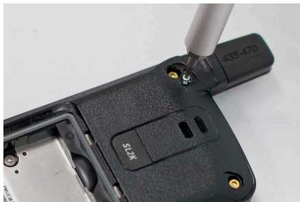
Figura 54: Riassemblaggio della vite dell'antenna
