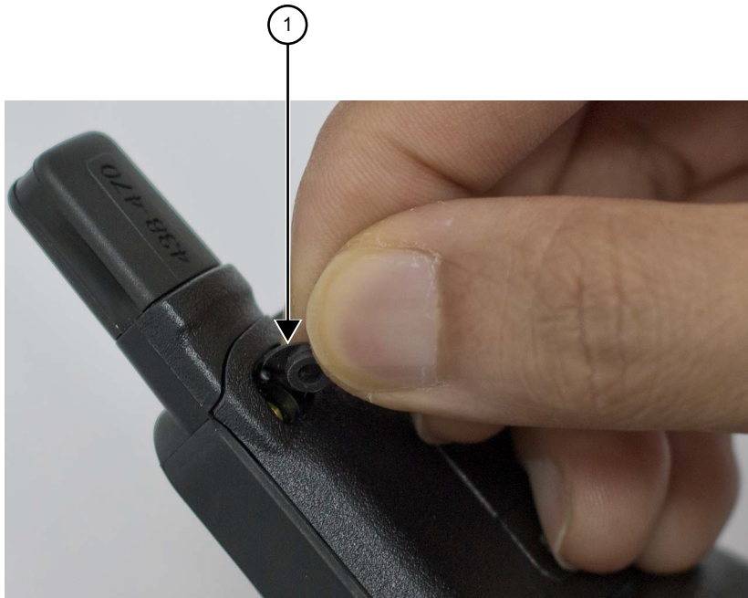
Figure 11: Retrait du connecteur de l'antenne avec les doigts
