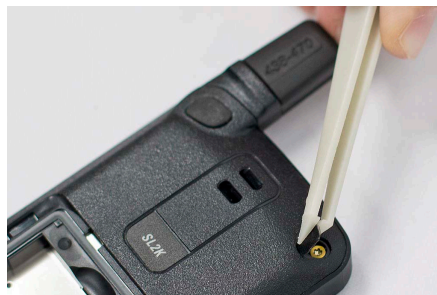
Abbildung 56: Anbringen der Typenschild-Abdeckung
