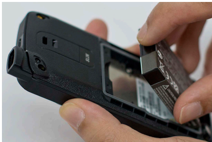
Rysunek 17: Wyjmowanie akumulatora
