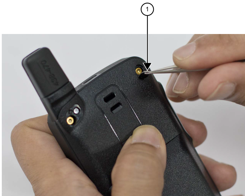
Rysunek 12: Zdejmowanie pokrywy tarczy za pomocą szczypiec
