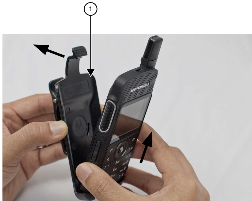
Figura 9: Rimozione della custodia
