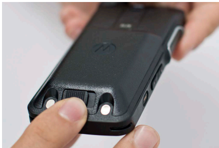
Figure 52: Verrouillage du cache de la batterie
