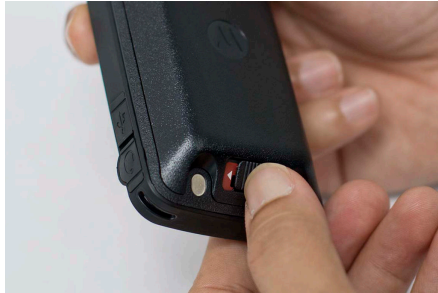
Abbildung 15: Entriegeln der Akkufachabdeckung
