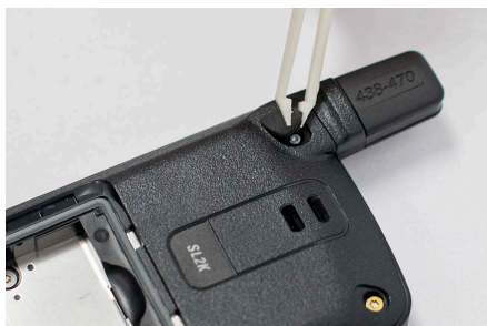
Figura 55: Riassemblaggio del tassello dell'antenna
