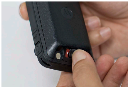
Figura 15: Desenganche de la puerta del compartimento de la batería
