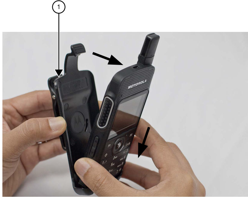
Şekil 57: Tutucunun Yeniden Takılması
