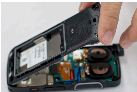
Figure 47: Remontage du boîtier arrière
