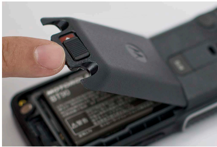
Figure 51: Remontage du cache de la batterie
