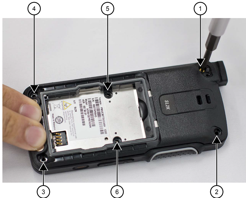
Rysunek 49: Zakończono ponowny montaż śrub
