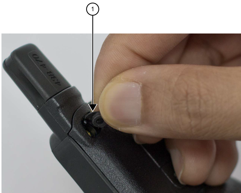
Рисунок 11: Снятие заглушки антенны пальцами
