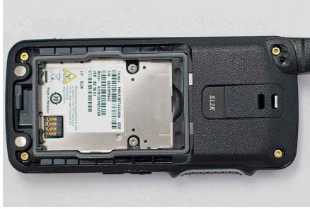
Şekil 49: Vidaların Yeniden Takılması (Tamamlanmış)
