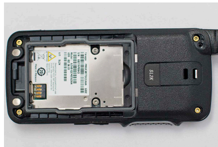
Figure 49: Remontage des vis terminé
