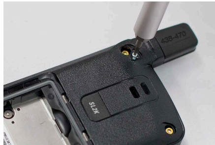
Abbildung 54: Montage der Antennenschraube
