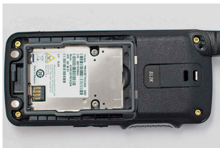
Abbildung 49: Wiederanziehen der Schrauben abgeschlossen
