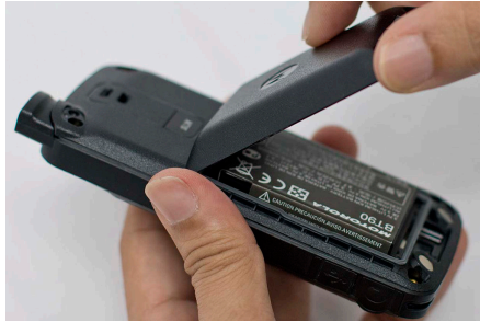
Figure 16: Retrait du cache de la batterie
