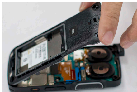
Figura 47: Montaje de la carcasa trasera
