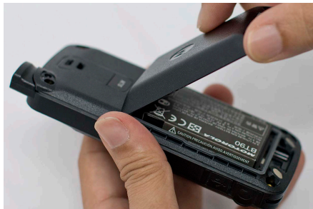
Abbildung 16: Entfernen der Akkufachabdeckung
