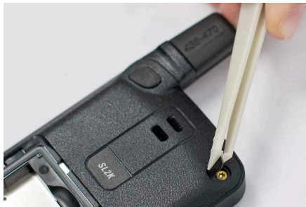
Figure 56: Remontage du nouveau cache-vis
