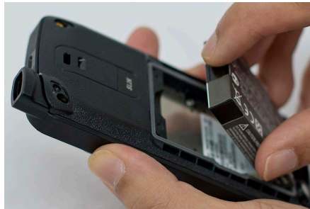
Figura 17: Retirada de la batería
