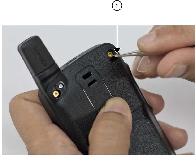
Şekil 12: Vida kapağının cımbızla çıkarılması
