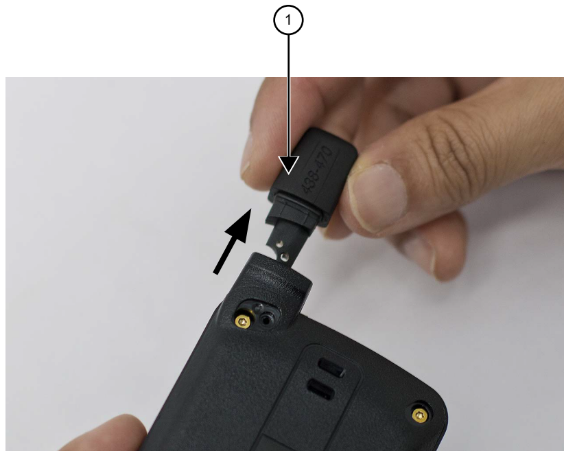
Figura 14: Retirada de la antena
