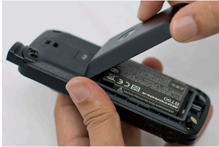
Figura 16: Extracción de la puerta del compartimento de la batería
