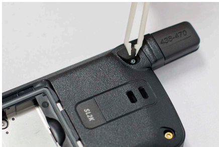
Figura 55: Montaje del tapón de la antena
