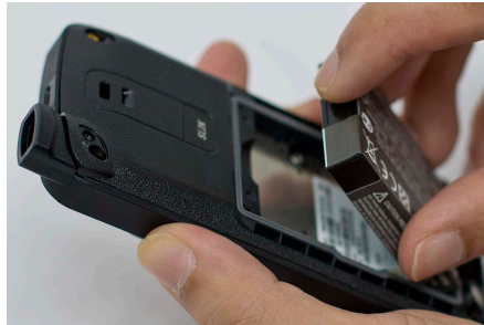
Figure 17: Retrait de la batterie
