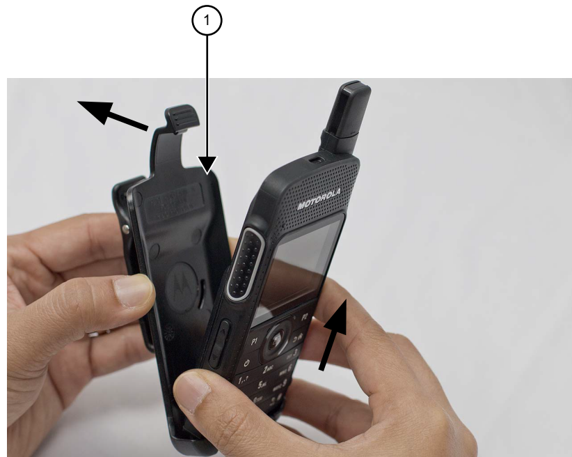
Abbildung 9: Entfernen der Gürteltasche
