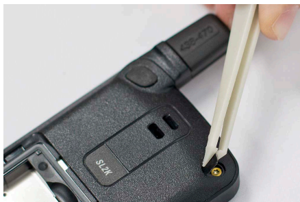
Figura 56: Riassemblaggio del nuovo coperchio della bocchetta
