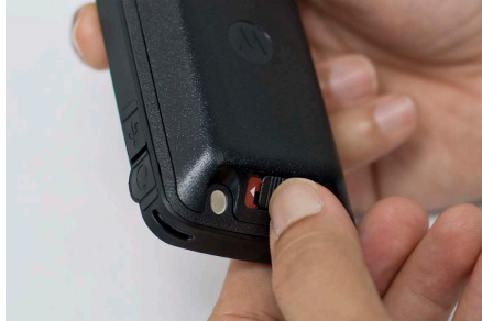
Figura 15: Sblocco dello sportello della batteria
