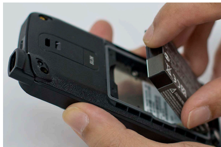
Abbildung 17: Entnehmen des Akkus
