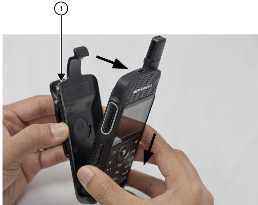
Figura 57: Reensamblaje de la funda
