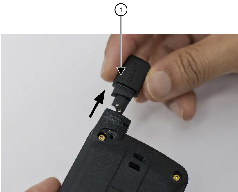
Rysunek 14: Wymowanie anteny
