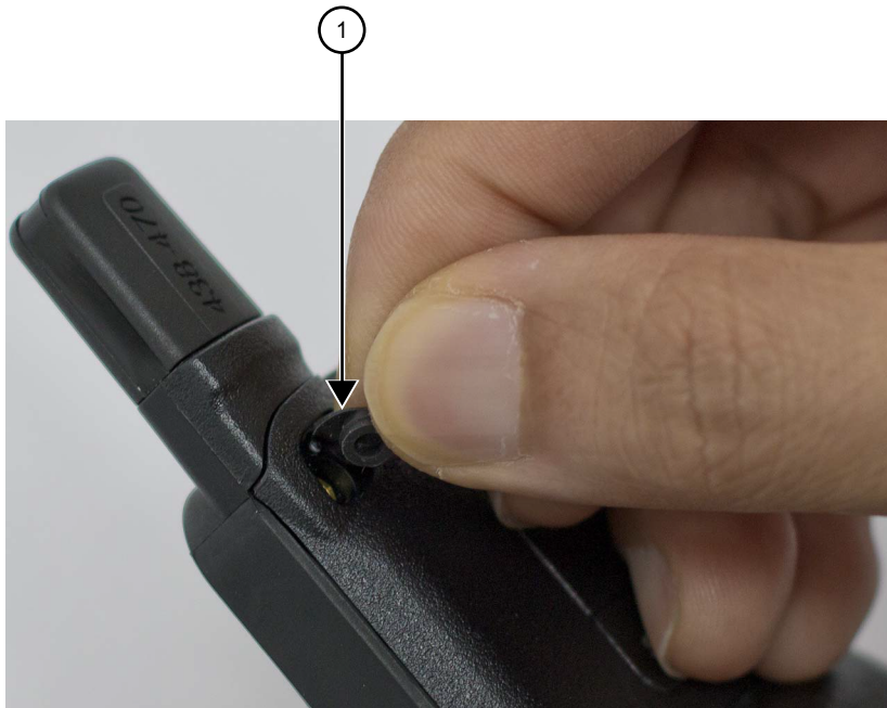
Abbildung 11: Entfernen des Antennensteckers mit den Fingern
