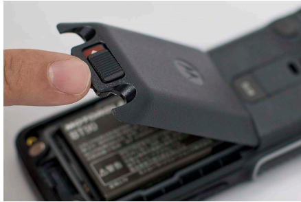
Figura 51: Montaje de la tapa de la batería
