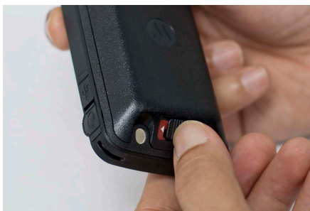
Figure 15: Déverrouillage du cache de la batterie
