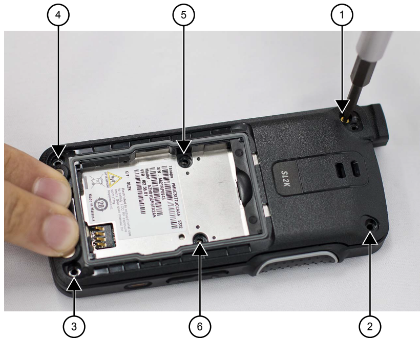
Рисунок 49: Сборка винтов завершена
