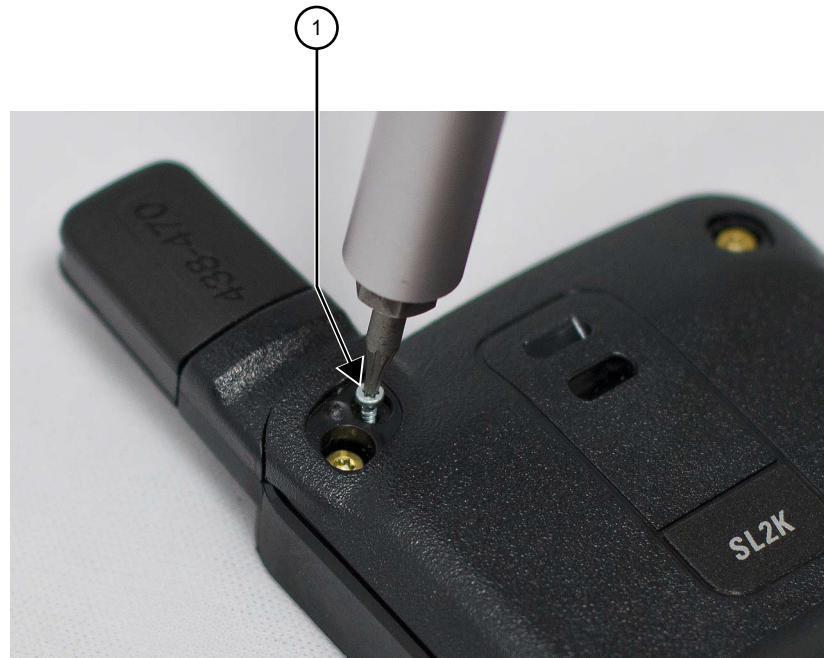
Figure 13: Retrait de la vis de l'antenne
