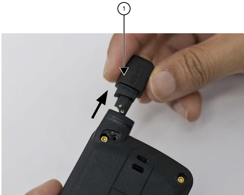
Figure 14: Retrait de l'antenne
