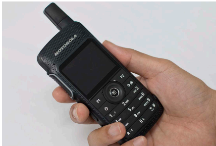
Figura 11: Rimozione del tassello dell'antenna con le dita
