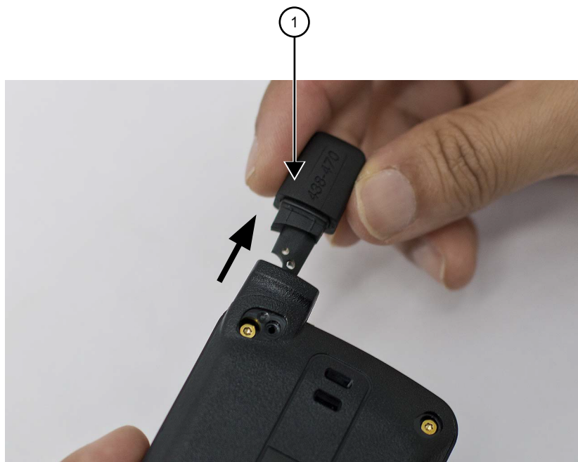
Abbildung 14: Entfernen der Antenne
