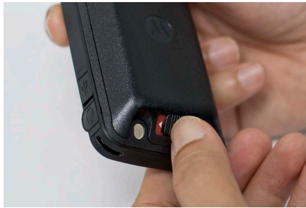
Şekil 15: Pil kapağı mandalının açılması
