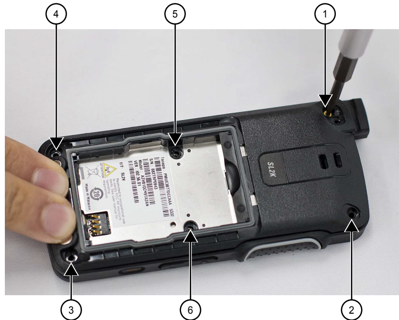
Figura 49: Riassemblaggio delle viti completato
