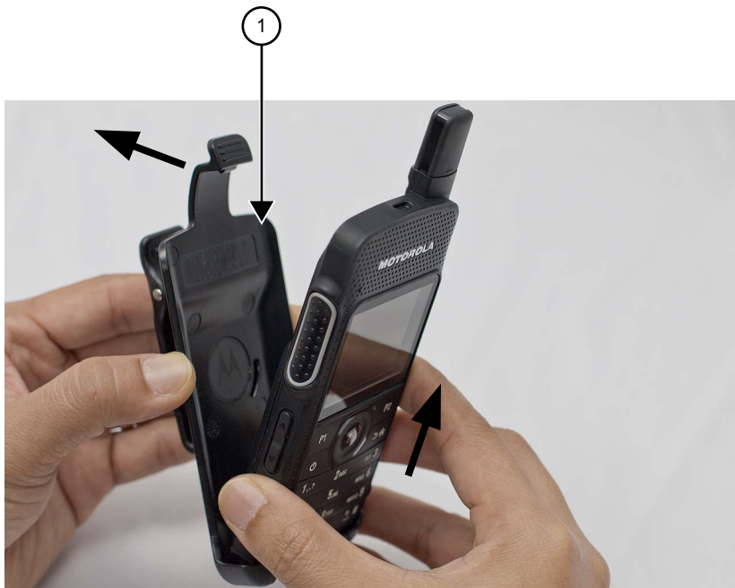
Figura 9: Retirada de la funda
