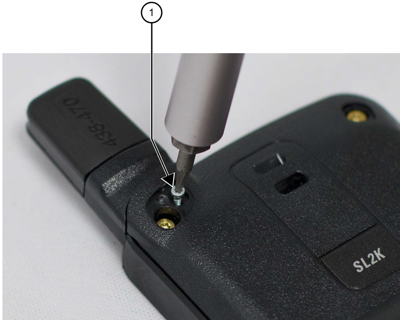
Figura 13: Extracción del tornillo de la antena
