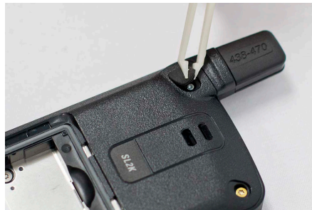
Рисунок 55: Сборка заглушки антенны
