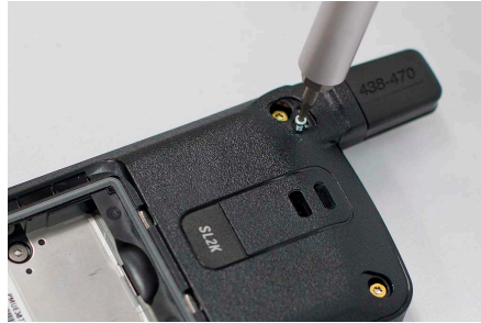
Рисунок 54: Завинчивание винта антенны
