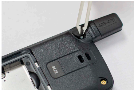
Figure 55: Remontage de la prise de l'antenne
