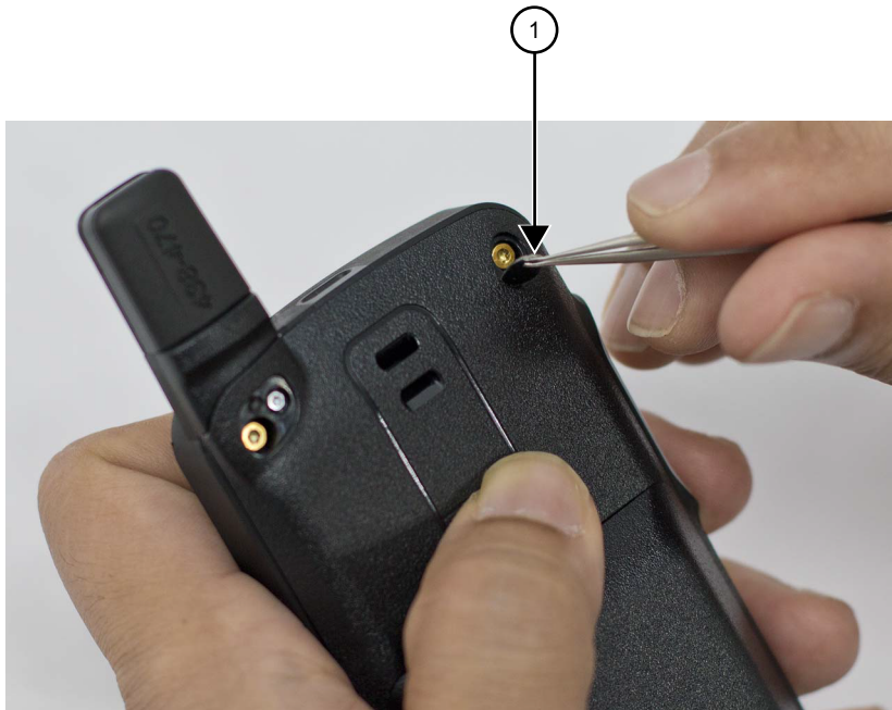
Figure 12: Retrait du cache-vis à l'aide d'une pince
