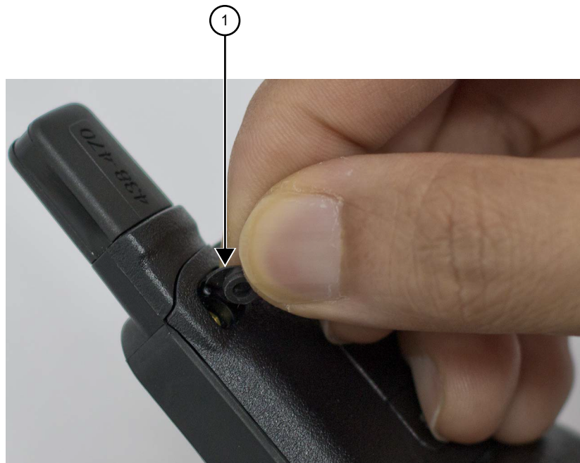
Figura 11: Extracción del tapón de la antena con los dedos
