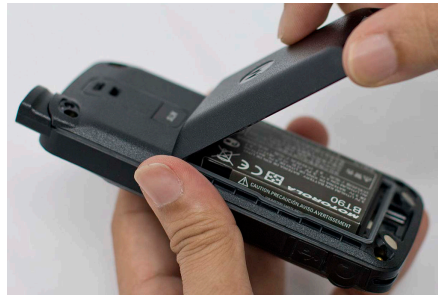
Рисунок 16: Снятие крышки аккумуляторного отсека
