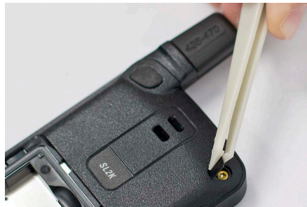
Рисунок 56: Сборка новой защитной крышки
