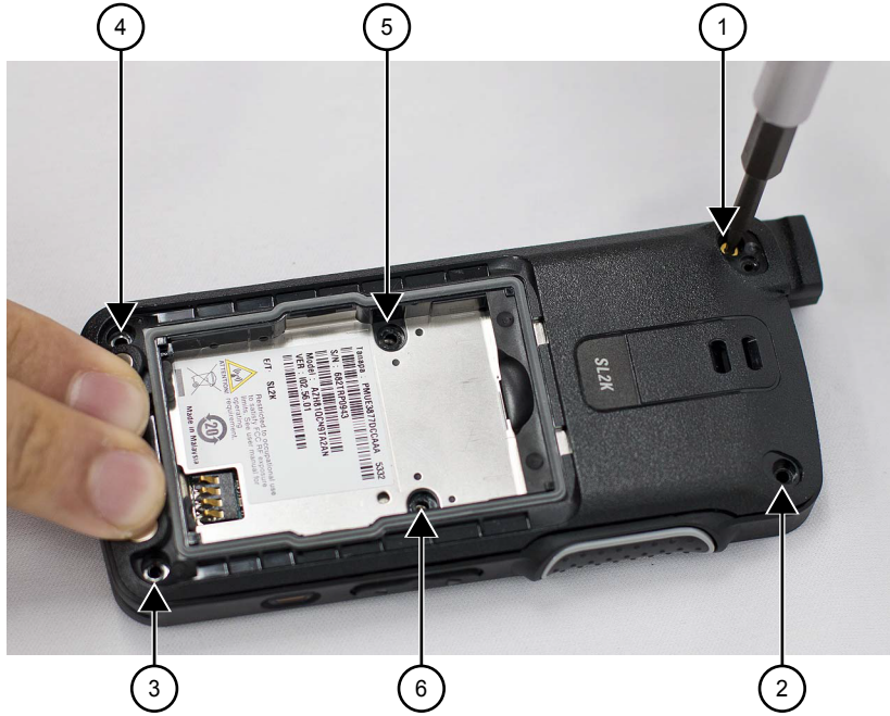
الشكل 49: إعادة تجميع مكتمل للبراغي
