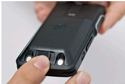
Figura 52: Cierre de la tapa de la batería
