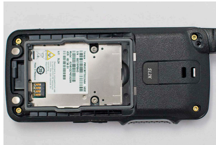
Рисунок 49: Сборка винтов завершена
