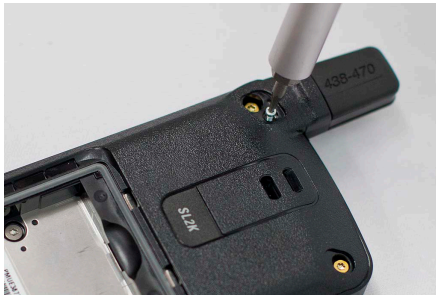
Figura 54: Montaje del tornillo de la antena
