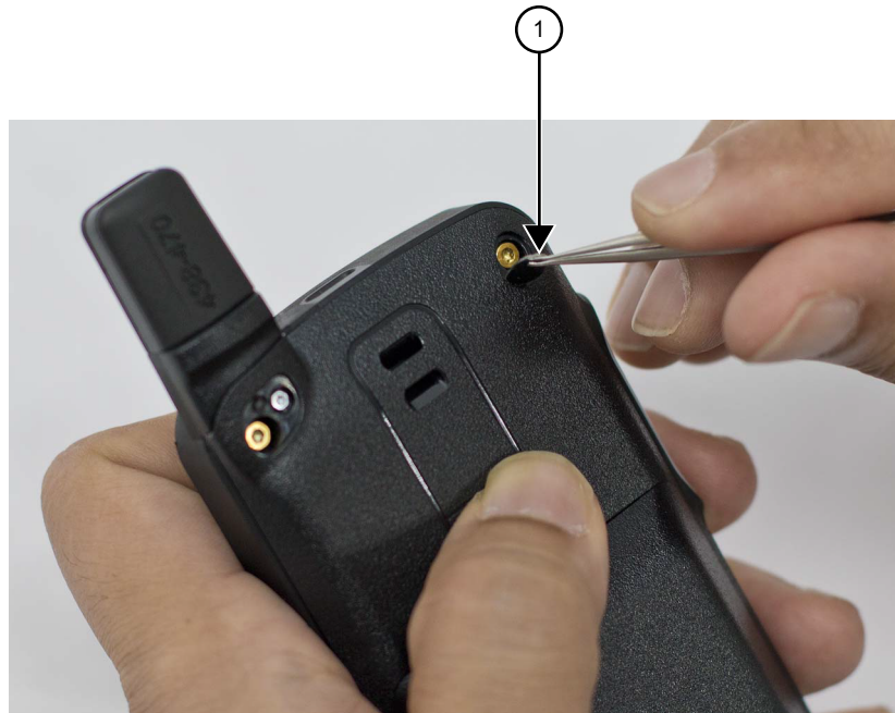
Figura 12: Rimozione del coperchio della bocchetta con una pinzetta
