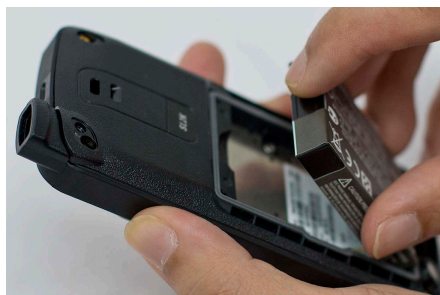
Figura 17: Rimozione della batteria
