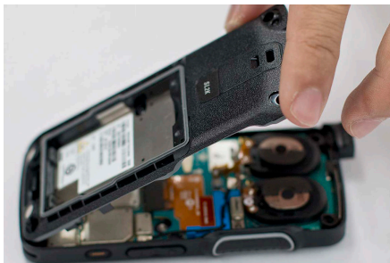
Рисунок 47: Сборка задней части корпуса
