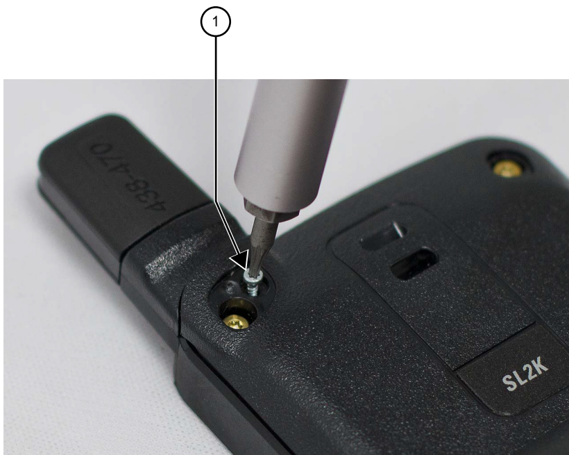
Rysunek 13: Odkręcanie śruby anteny
