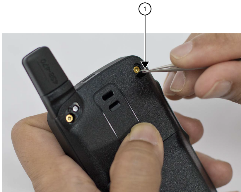
Figura 12: Extracción de la cubierta protectora con unas pinzas
