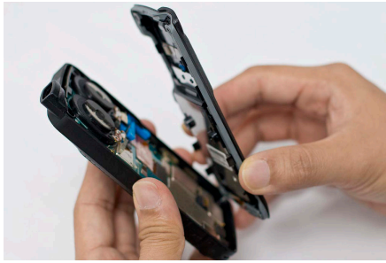
Рисунок 19: Снятие задней части корпуса
