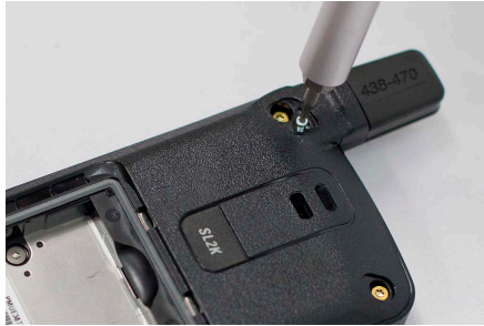
Figure 54: Remontage de la vis de l'antenne
