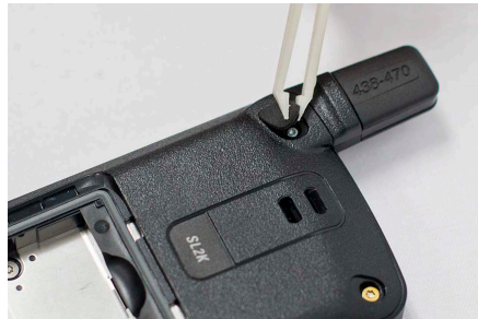
Abbildung 55: Montage des Antennensteckers
