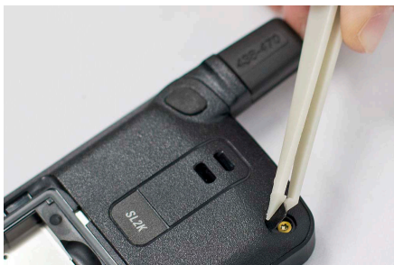
Figura 56: Montaje de la nueva tapa de la cubierta protectora
