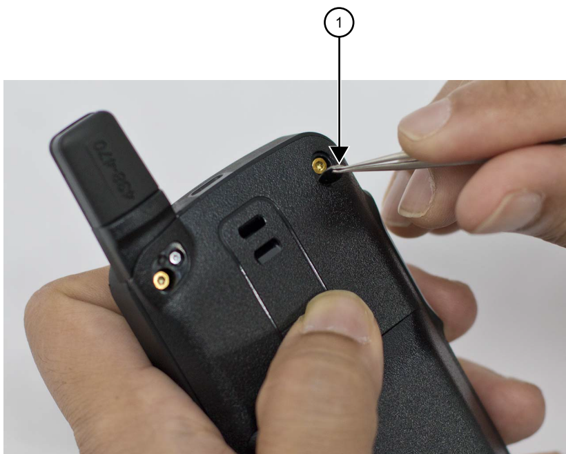
Рисунок 12: Снятие защитной крышки с помощью пинцета
