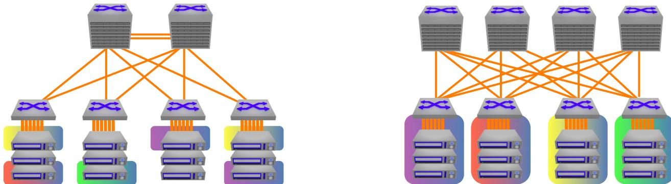
Arista 模块化系统叶脊设计在 16 路 ECMP 设计中按 3:1 订阅规模扩展至 55,296 个 25/50GbE 端口
