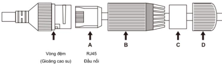
3. Sử dụng công cụ lắp cáp Ethernet để lắp đầu nối RJ45 vào với đầu cáp Ethernet không bị cắt.
