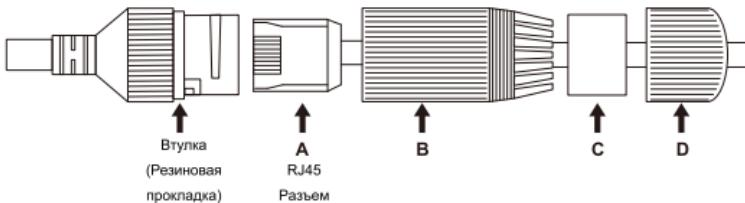
3. Установите разъем RJ45 на открытый конец кабеля Ethernet с помощью кабельного инструмента.
