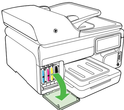
2. 交換の必要なインク カートリッジを持って手前に引き、取り外します。
