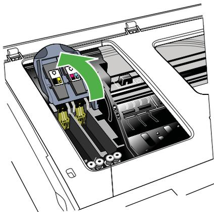
4. プリントヘッドのハンドルを持ち上げて、プリントヘッドをスロットから引き出します。
