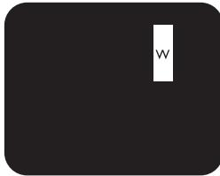
Tre tilstøtende belyste underpiksler (en hvit piksel).
