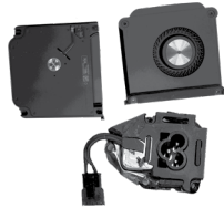
พัดลมและช่องจ่ายไฟ AC
