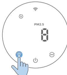
Med lyssensoren kan kontrollpanelet slå seg av/på eller dimmes automatisk i henhold til omgivelseslyset. Kontrollpanelet er avslått eller dimmet når omgivelseslyset er av. Du kan trykke på en hvilken som helst knapp for å aktivere
