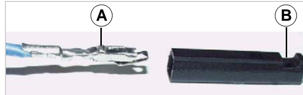
[19] Federkontakt in 1poliges Buchsengehäuse stecken.
