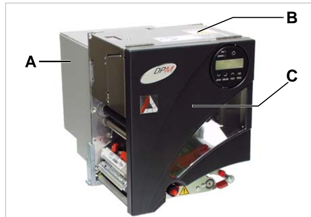
[1] Das DPM-Gehäuse besteht aus den Teilen: A Rückhaube DPM B Fronthaube DPM C Frontblende (Bestandteil der Fronthaube)
