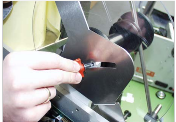
[11] Sensorbügel an der Halteplatte festschrauben.
