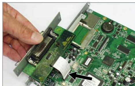
[5] Einbaulage der Platine. Die silbernen Kontakte (E) des FFC-Kabels müssen beim Anstecken nach rechts zeigen (Pfeil).
