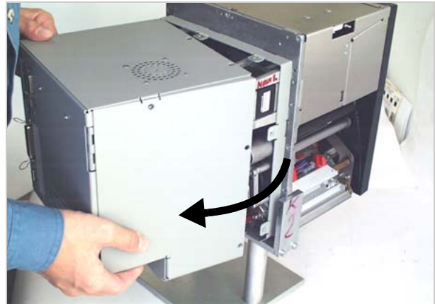
[7] Rückhaube öffnen. Dabei gleichzeitig das rechte Seitenteil aufklappen.
