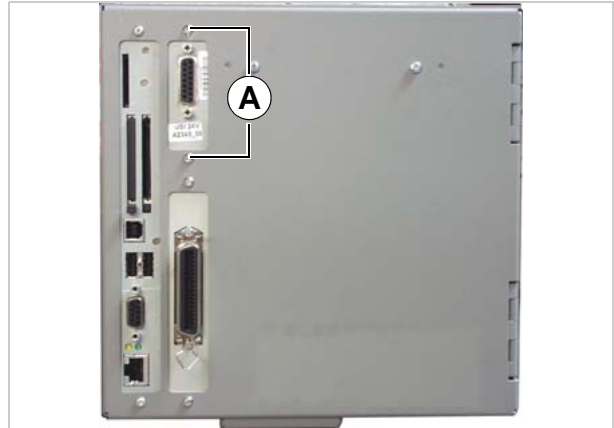
[188] Befestigung (A) der USI-Platine an der Rückwand.
