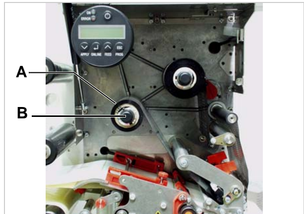
[58] Folien-Abrollhorn (A) mit Kappe (B) (ALX RH).
