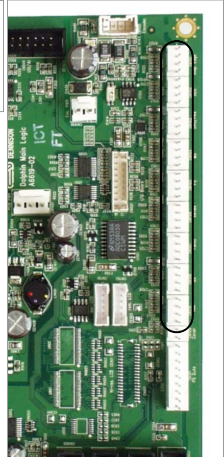
[3] Rechts: Gelb markiert = Sensor-Anschlüsse auf der CPU-Platine.
