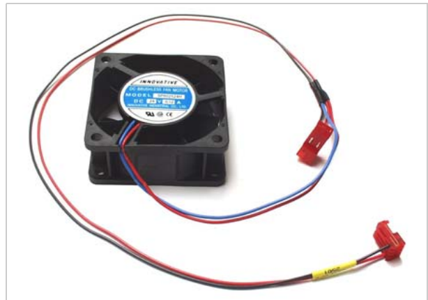
[9] Lüfter für die DPM. Das Kabel hat zwei Stecker - für den Anschluss an Netzteil und USI. (Elektronik Gen. 2).
