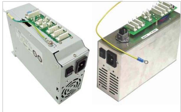
[231] Links: ME500-Netzteil; Rechts: HME-Netzteil
