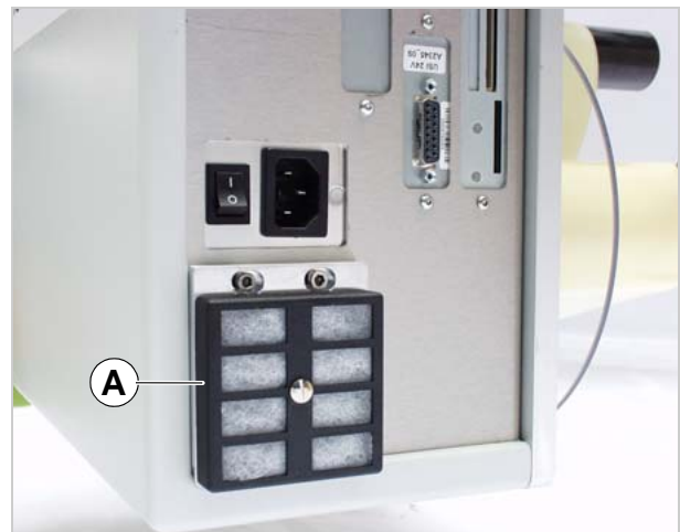
[17] Staubfilter (A) montiert.
