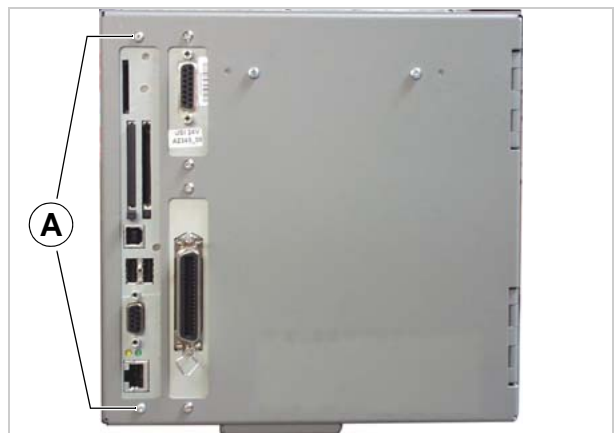
[193] Befestigung (A) der CPU-Platine an der Rückwand.
