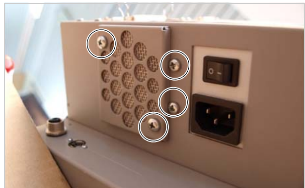
[225] Befestigung am Gehäuseboden.
