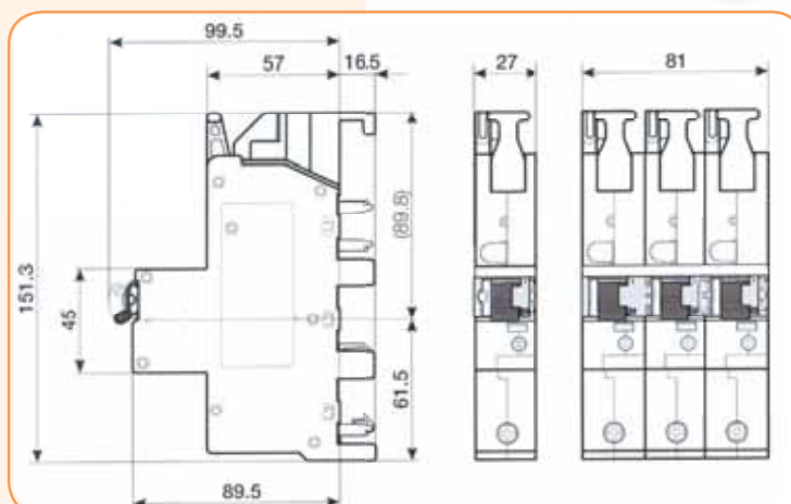
Bieguny L1, L2, L3 są załączane oddzielnie
