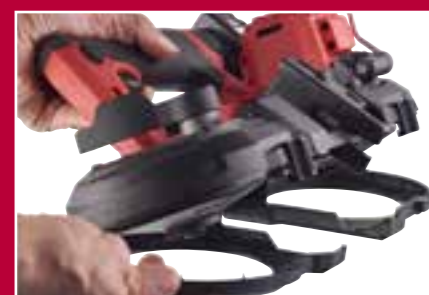
Защитные чехлы предохраняют пользователя от травм, предотвращая любой контакт пользователя с лезвием. Безинструментная замена чехлов занимает несколько секунд
