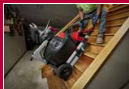
Встроенные гусеницы POWERTREDZ™ помогает перемещать машину в одиночку в фургон / из фургона и вверх / вниз по лестнице
