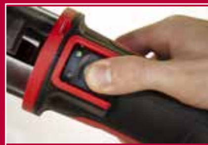
FORCE LOGIC™ индикатор обжима
