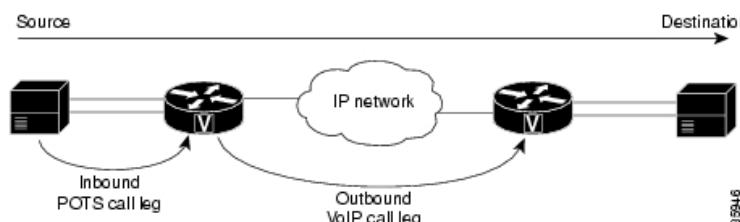
Рис. 24. Ветви вызовов с точки зрения окончного маршрутизатора
