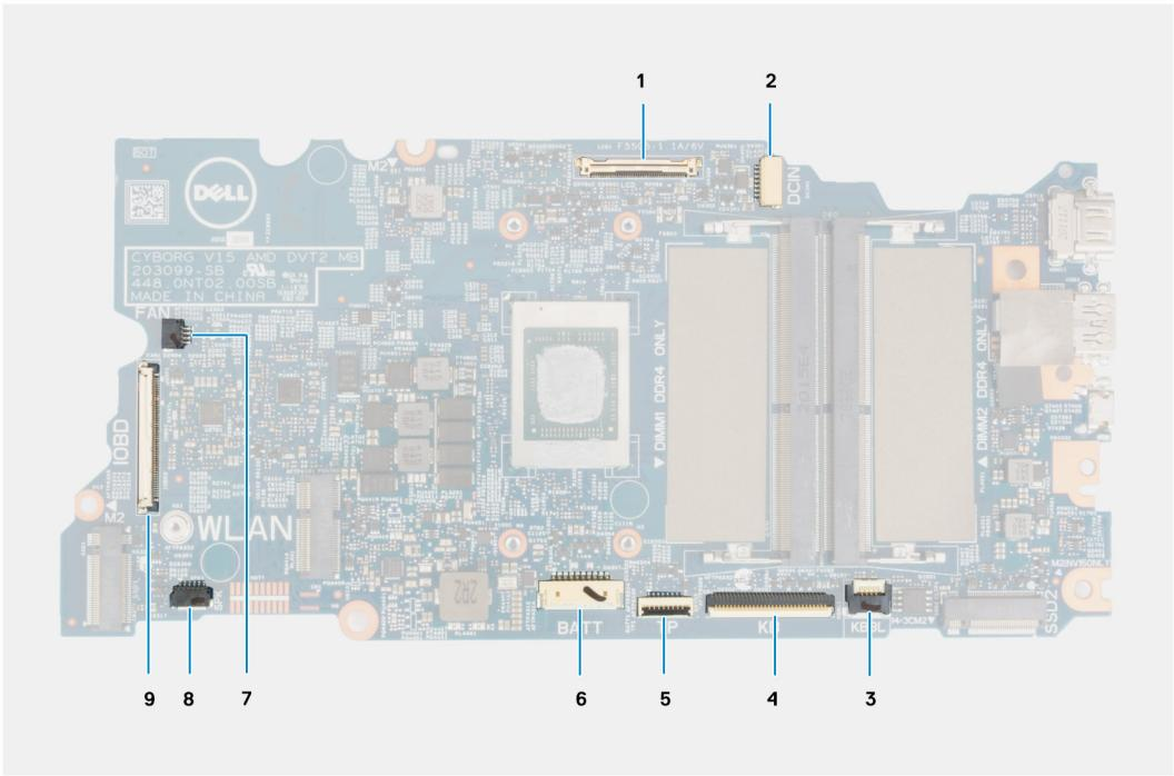
图 2: 系统板连接器
