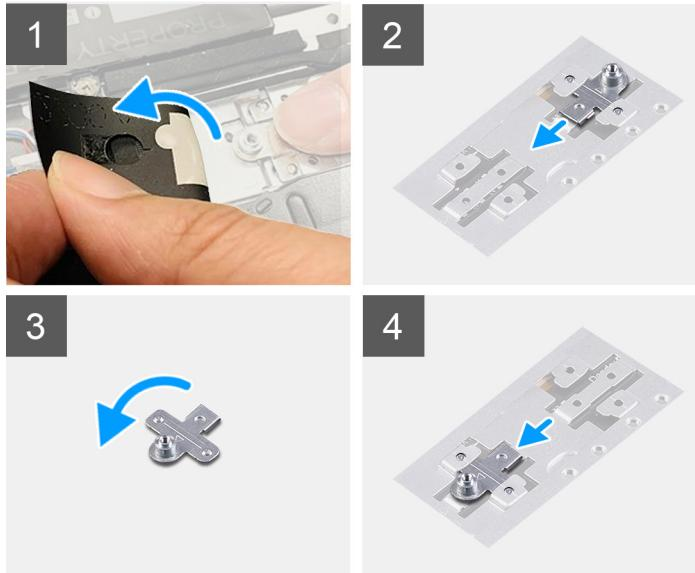
下图提供了在 M.2 插槽 1 中将 M.2 2280 固态硬盘更换为 M.2 2230 固态硬盘时安装固态硬盘固定支架的过程的可视化表示。
