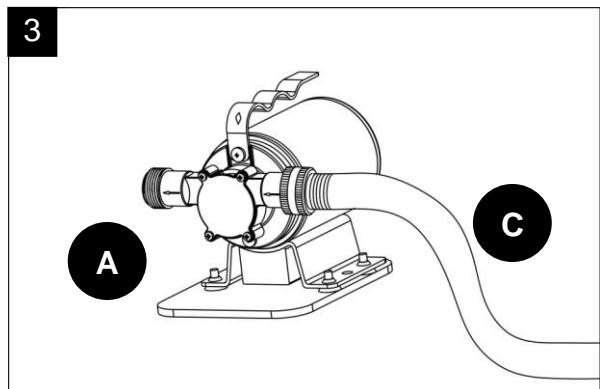
4. Enrosque una manguera de jardín de 15,88 mm o más grande (se vende por separado, longitud máx. de 15,24 m) en la salida de descarga de la bomba (A).
