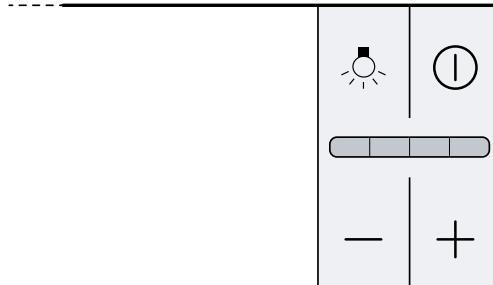
① Uključivanje ili isključivanje uređaja
