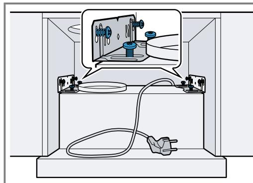
2. Širina uređaja 90 cm: izvlačivi deo filtera potpuno povucite ka napred. Pomoću 2 zavrtnja dodatno pričvrstite uređaj na bočne gornje kuhinjske elemente odozdo sa leve i desne strane.
