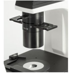
N. A. 0,3 Abbe Kondensator mit Phasenkontrastschieber
