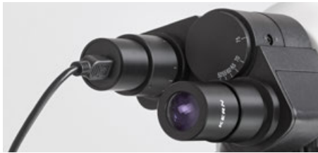
Okularkamera am Tubus befestigt
