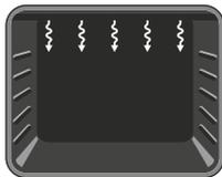
**Función de grill:** Las luces de advertencia y del termostato del horno se encenderán y comenzará a operar el elemento de calentamiento del grill.
