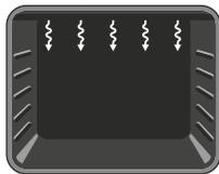
**Fonction Gril :** Le voyant du thermostat et la lampe témoin du four s'allument, et la résistance du gril commence à chauffer. Cette fonction sert à
