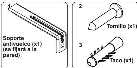
La bolsa de los documentos incluye un kit antivuelco. Fije con holgura el soporte antivuelco (1) a la pared mediante el tornillo (2) y el taco (3), respetando las medidas
