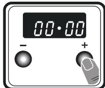
2. Ajuste la hora mientras esté parpadeando el punto mediante los botones “+” y “-”.
