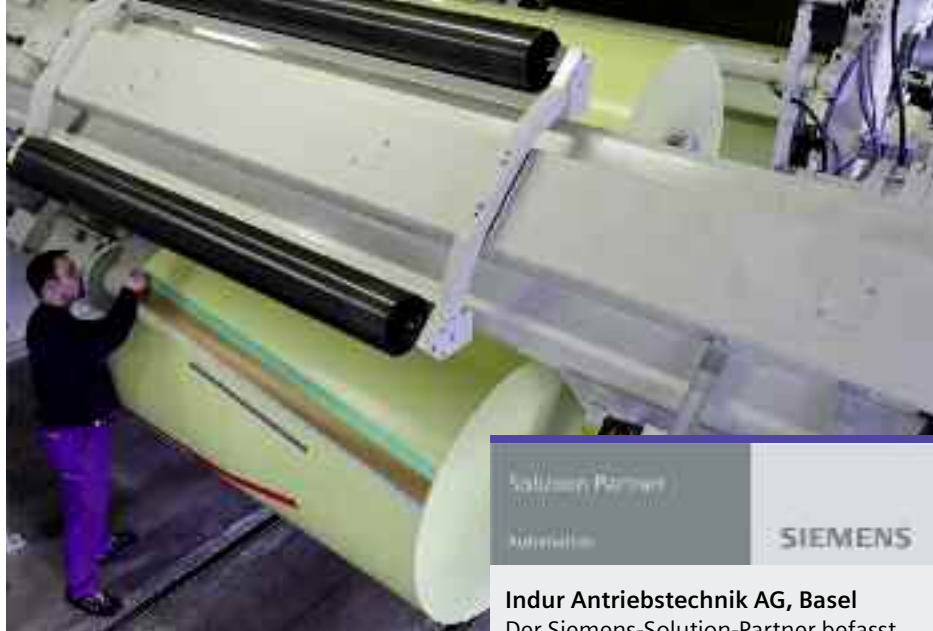
Das Zwischenlager bestückt die Beschichtungsanlage mit Rohmaterial und nimmt die beschichteten Rollen wieder ab.
