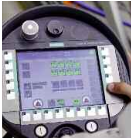
Das Mobile Panel 277 erlaubt kabelloses Bedienen und Beobachten mit Standard- oder mit voller Sicherheitsfunktionalität.
